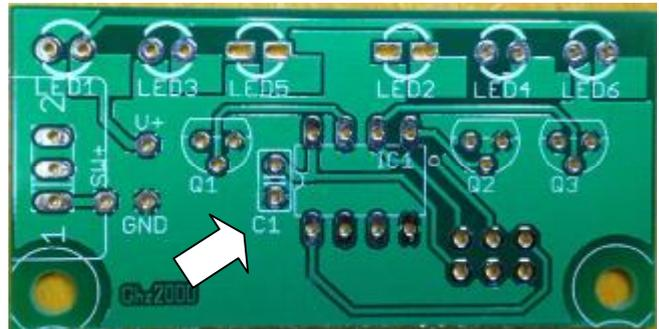
図 4 C1 セラミックコンデンサ
