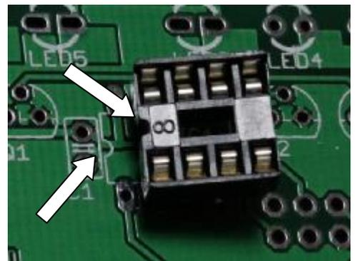
図 6 IC ソケットの切り欠き
